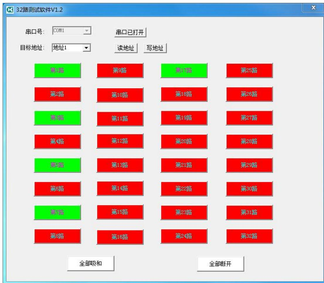
上图为继电器控制板与软件连接成功后图示，软件可以控制继电器动作，并显示继电器状态，软件图标红色代表断开，绿色代表闭合。
